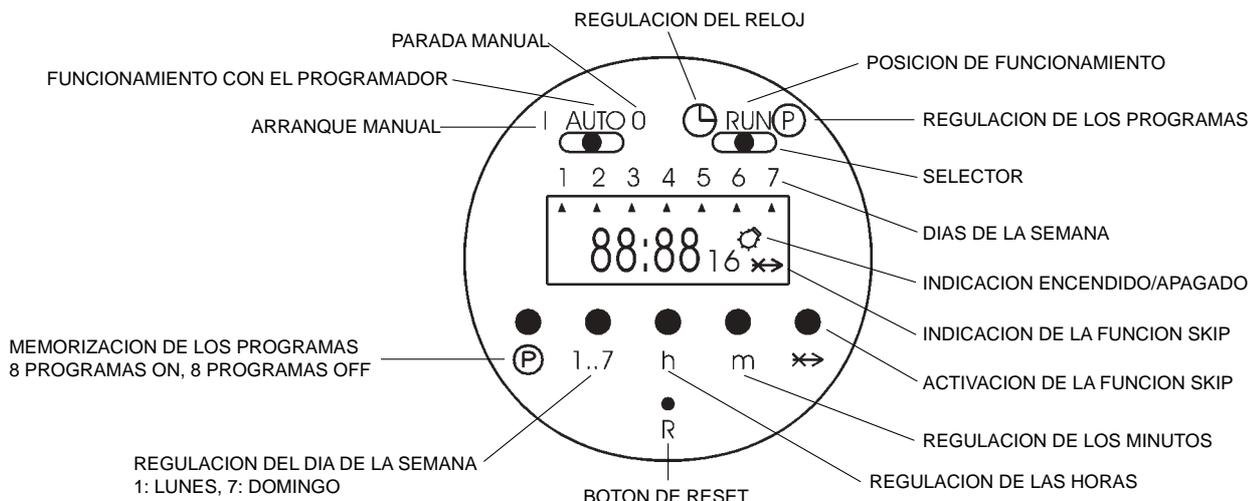
**Modos de funcionamiento del programador:**
